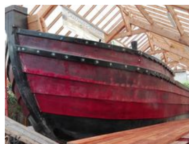
Août 2016: l'assemblage du plancher se poursuit ainsi que la mise en forme des bancs...
