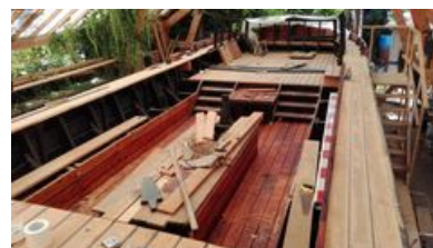
Août 2016: l'assemblage du plancher se poursuit ainsi que la mise en forme des bancs...
