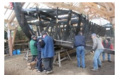
Après 4 heures en étuve, (mise en chauffe par Pascal à 5h30 du matin!), la première planche de bordé est présentée ...
